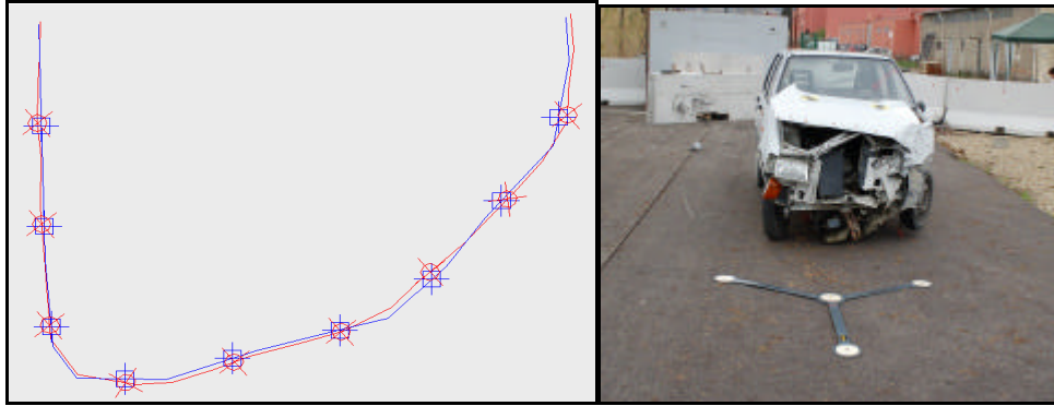
Figura 10: Confronto profilo deformato acquisito tramite fotogrammetria (rosso) e utilizzando la stazione totale (blu)
